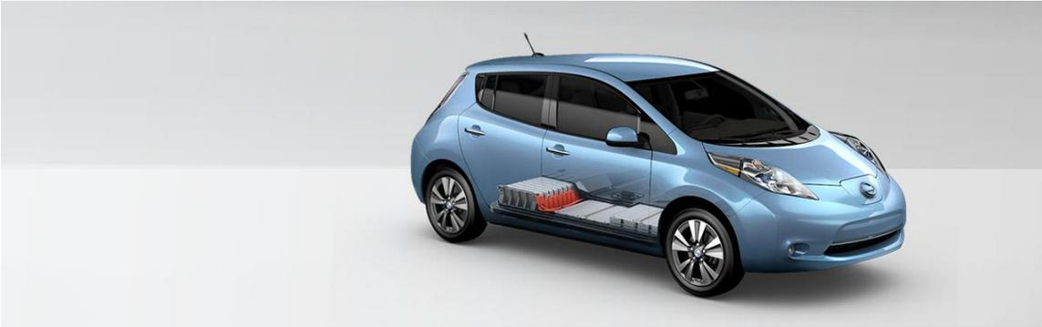
**Figure 24 : La localisation de la batterie dans une auto électrique**
